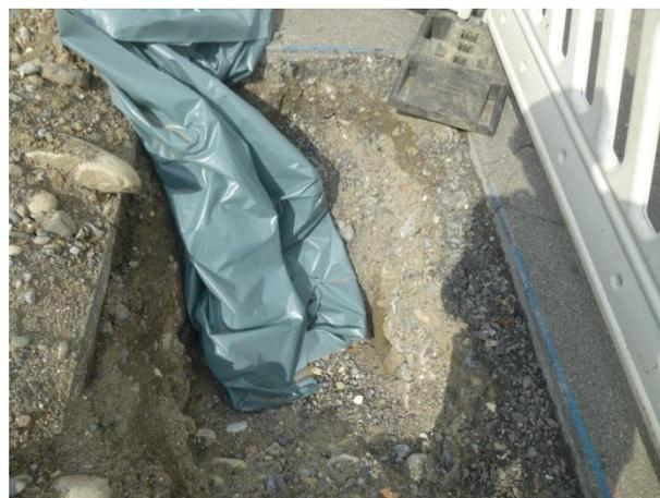
Abbildung 4: Sondage Aumattweg, Foundationsschicht rund 45 cm stark
