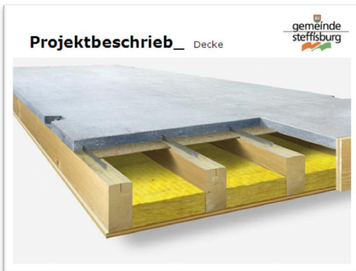
Auf dieser Folie wird eine Holzbetonverbunddecke dargestellt. Dies sind Holzelemente, welche bereits einen Betonbelag aufweisen.
