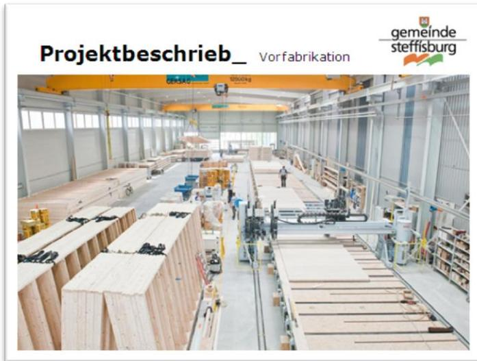
Hier wird die Bauweise dargestellt. In grossen Hallen werden die Holzelemente auf sogenannten Schmetterlingstischen vorfabriziert. Die Installationen werden bereits in die Wände integriert.
