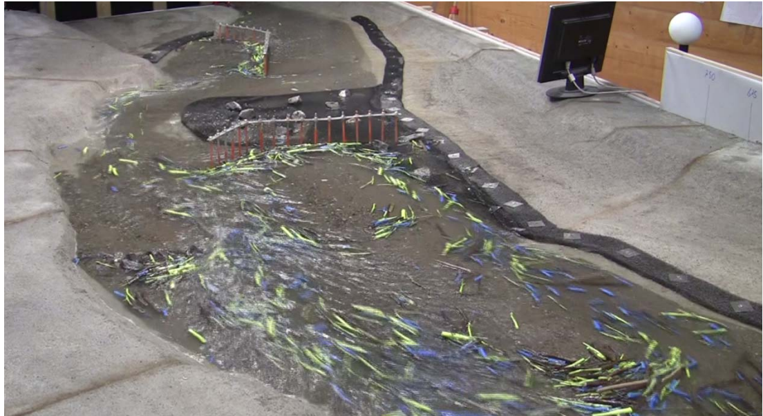
Abb. 7-2: Die lenkende Wirkung der Buhne während des Ereignisses ist zu gering.
