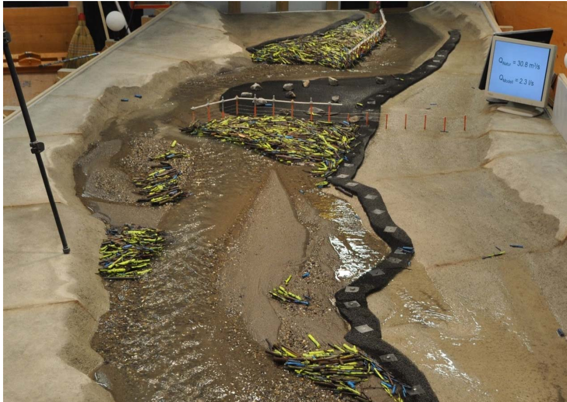
Abb. 8-9: Schwemmhholz- sowie Geschiebeablagerungen beim abklingendem Hochwasser des Versuches C8_1.1_142G.
