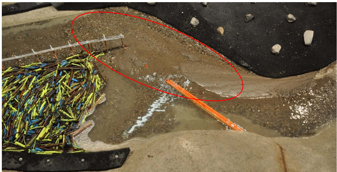
Abb. 7-35: Rot markiert sind die Geschiebeablagerungen ausserhalb des Parallelrechens.
