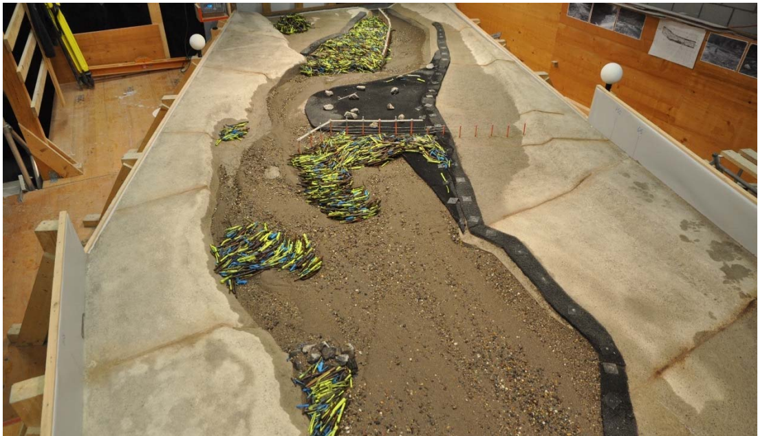
Abb. 7-27: Schwemmholzablagerungen nach dem Modellversuch B5_1.1_119_142S.
