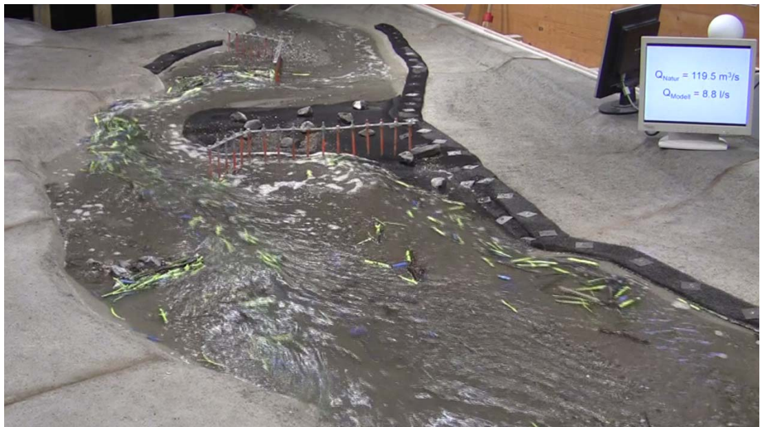
Abb. 7-4: Strömungssituation bei anstiegender Hochwasser (Zugabe 1. Schwemmholzpaket).
