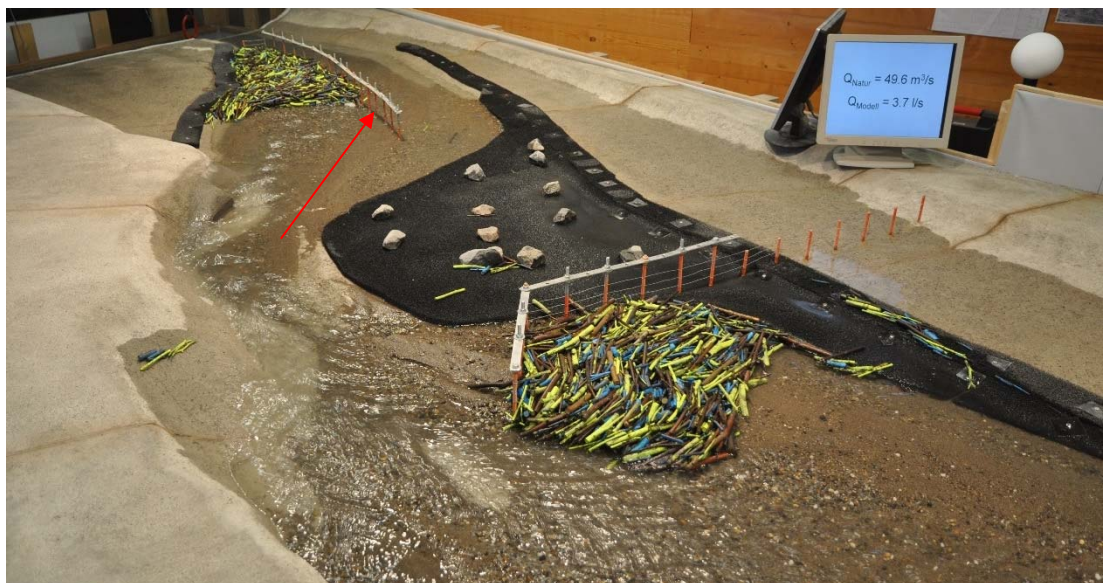
Abb. 7-48: Schwemmholtablagerungen bei abklingendem Hochwasser des Versuches B8_1.2_210G.
