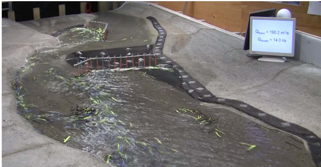
Abb. 7-13: Durch die Insel wird die Strömung geteilt, jedoch nicht in den V-Rechen gelenkt.
