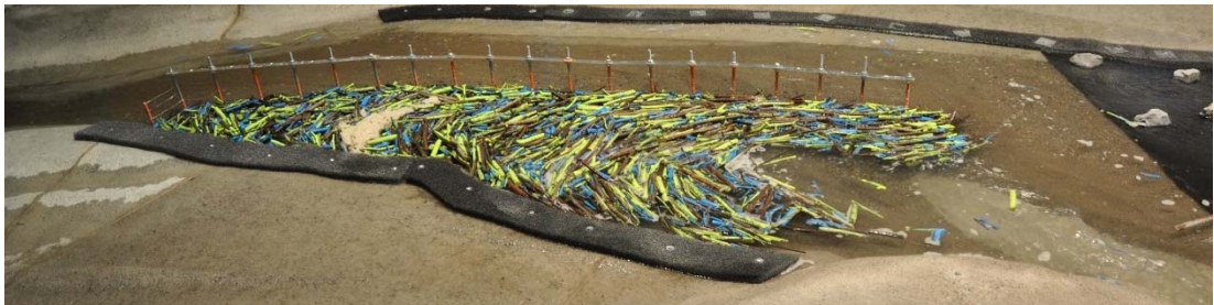
Abb. 7-20: Parallelrechen nach der dritten Schwemmh Holzfracht von 720 m 3 fest.
