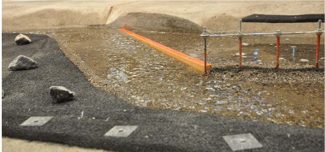
Abb. 7-39: Mit der Fliessrichtung ansteigendes Streichwehr (Fliessrichtung von links nach rechts).
