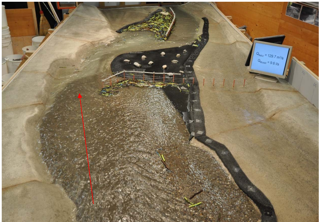
Abb. 9-7: Ohne Buhne wird der V-Rechen deutlich weniger angeströmt, wodurch der Schwemmhola-rückhalt geringer ausfällt.
