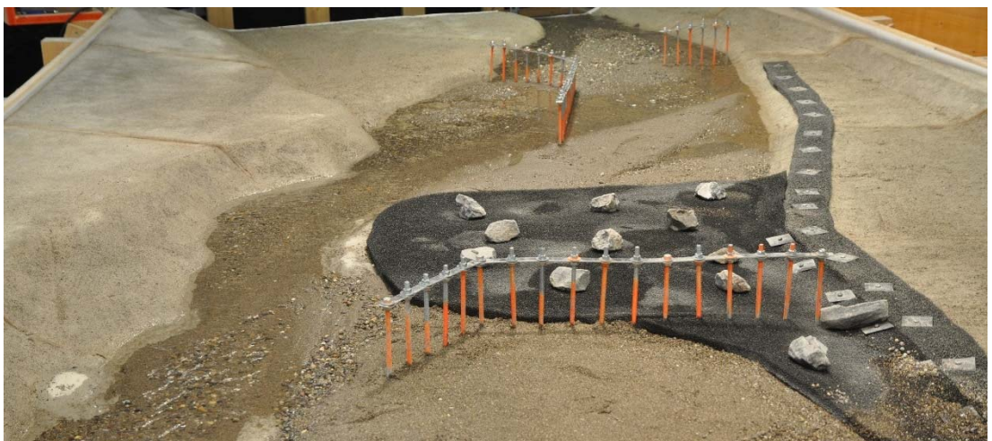
Abb. 6-13: Ausgangssohle mit eingebauten Rechen für den Versuch A2_1.1_210G.
