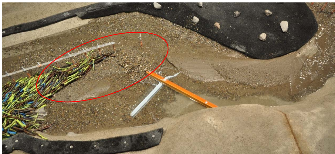
Abb. 7-33: Deutliche Geschiebeablagerungen (rot markiert) im Bereich ohne Streichwehr.
