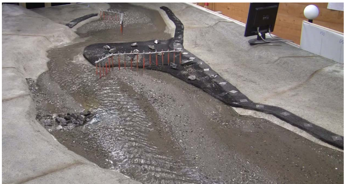
Abb. 7-1: Strömungslage vor dem Versuch. Die Strömung zielt Richtung linken Teil des V-Rechens.
