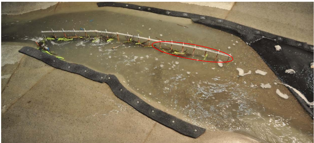
Abb. 8-13: Die Verklauungen im oberen Drittel (rot markiert) des Parallelrechens lösen sich bis zur Hochwasserspitze.
