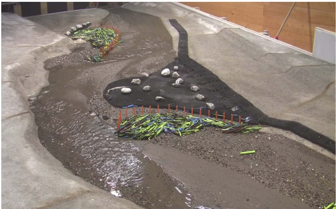
Abb. 6-3: Schwemmholzrückhaltesystem mit V-Rechen und Parallelrechen.
