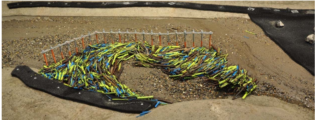
Abb. 7-5: Verklauete Öffnung des Parallelrechens infolge zu hoher Sohlenlage sowie ungünstiger Strömungslage.
