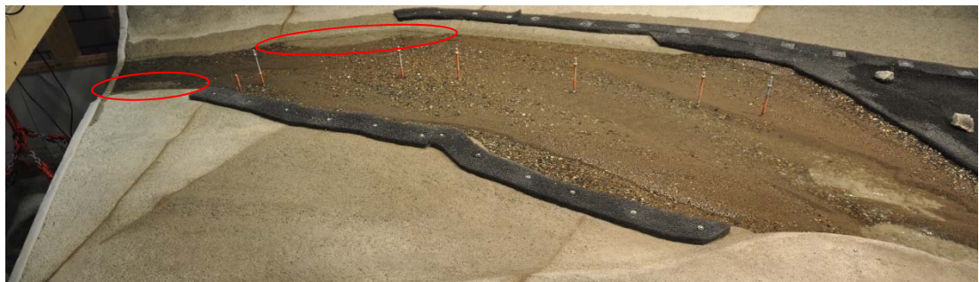
Abb. 8-10: Rot markiert sind die Bereiche der erodierten Sohle im untersten Modellabschnitt.
