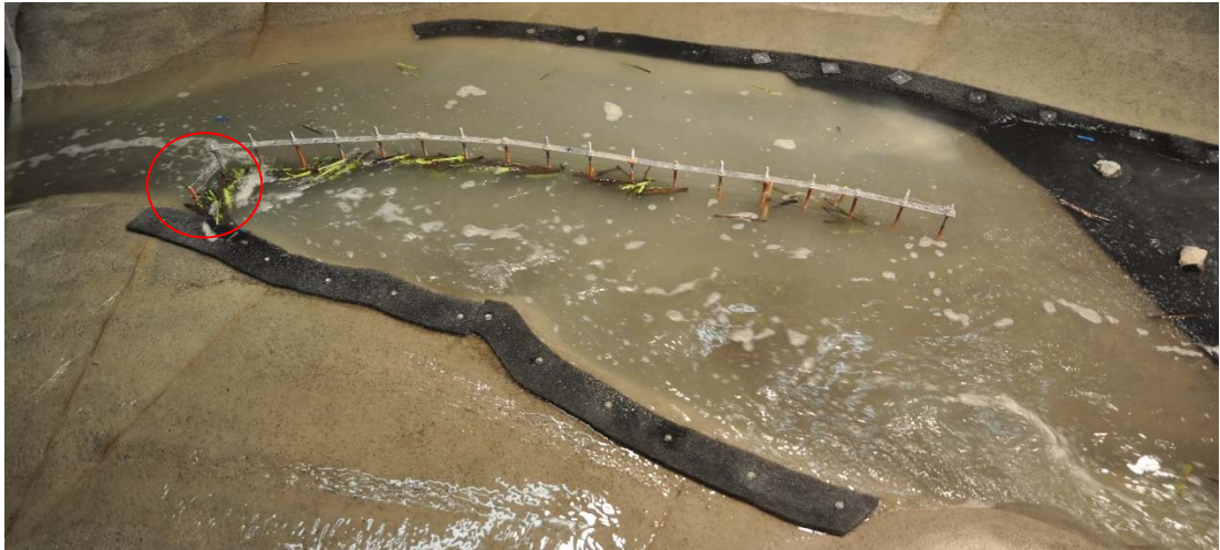
Abb. 8-17: Der Schwemmholzaustrag aus dem Parallelrechen findet grösstenteils durch die Öffnung zwischen den zwei letzten Stäben des Parallelrechens statt (rot markiert).
