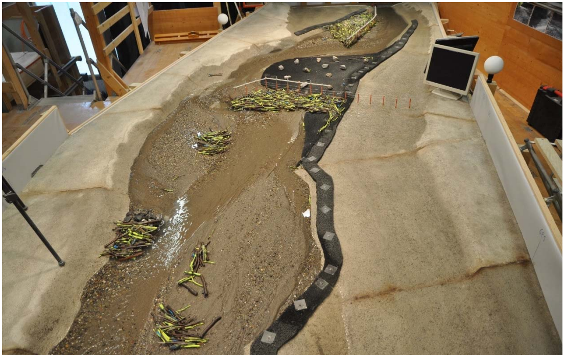
Abb. 8-6: Schwemmholz- und Geschiebeablagerungen nach dem Versuch C8_1.1_119G.
