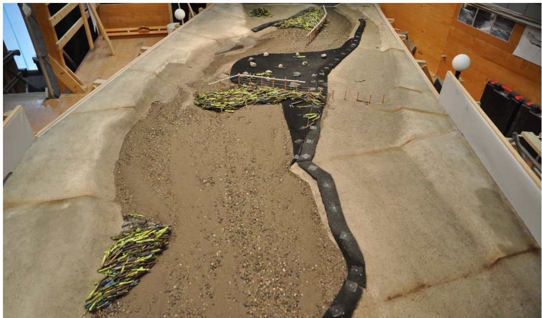
Abb. 8-15: Geschiebe und Schwemmholzablagung nach dem Versuch C8_1.1_210G.
