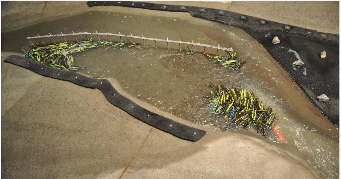
Abb. 7-52: Schwemmholzablagerung auf dem Streichwehr verhindert den Rückhalt von weiteren Schwemmholzfrachten im Parallelrechen.
