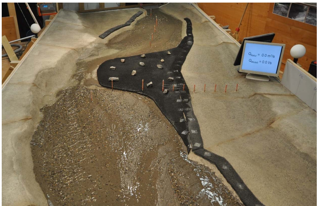
Abb. 8-16: Geschiebeablagerungen im Bereich der Aufweitungen nach dem Versuch C4_1.1_280G.
