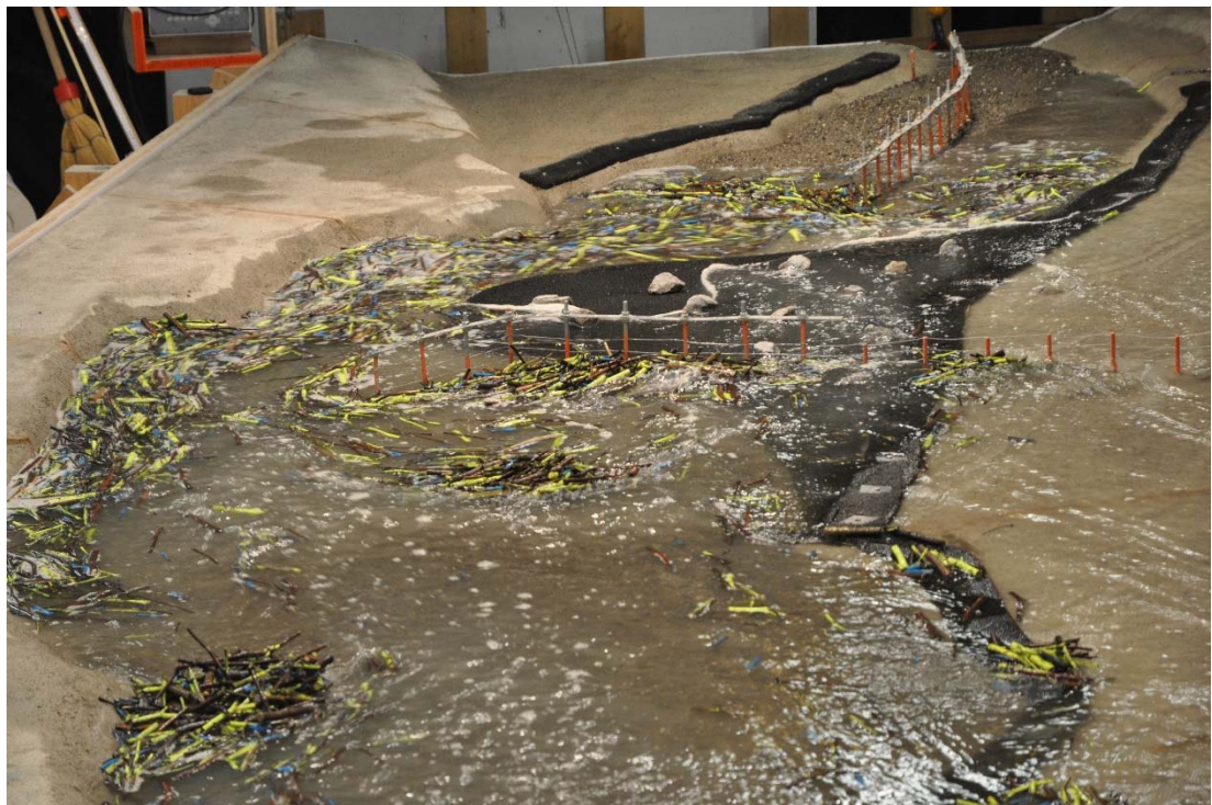
Abb. 9-9: Flutwelle mit einer Abflussspitze von 300 m 3 /s und einer Schwemmholzfracht von 2000 m 3 .
