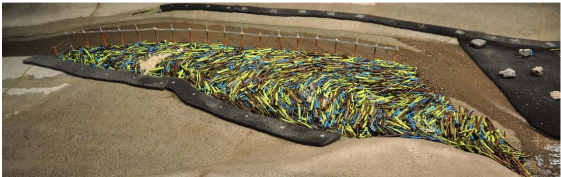
Abb. 7-22: Parallelrechen nach der fünften Schwemmh Holzfracht von 720 m 3 fest.
