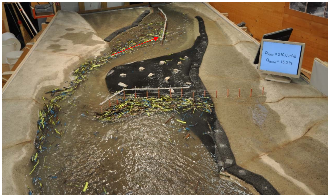
Abb. 9-4: Durch die Strömungslage, infolge der Auflandung, wird die Gefahr einer Querverklausung der Parallelrechenöffnung grösser.
