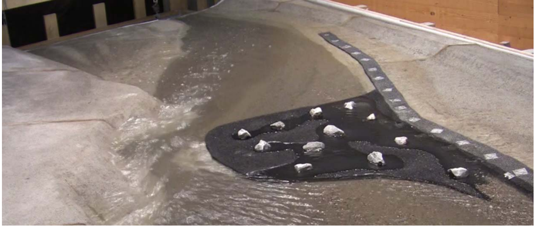
Abb. 6-12: Ausuferungen am linken und rechten Ufer während der Hochwasserspitze.
