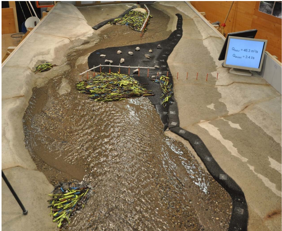
Abb. 9-2: Schwemmh Holzablag erungen des Versuches D8_1.1_210G.
