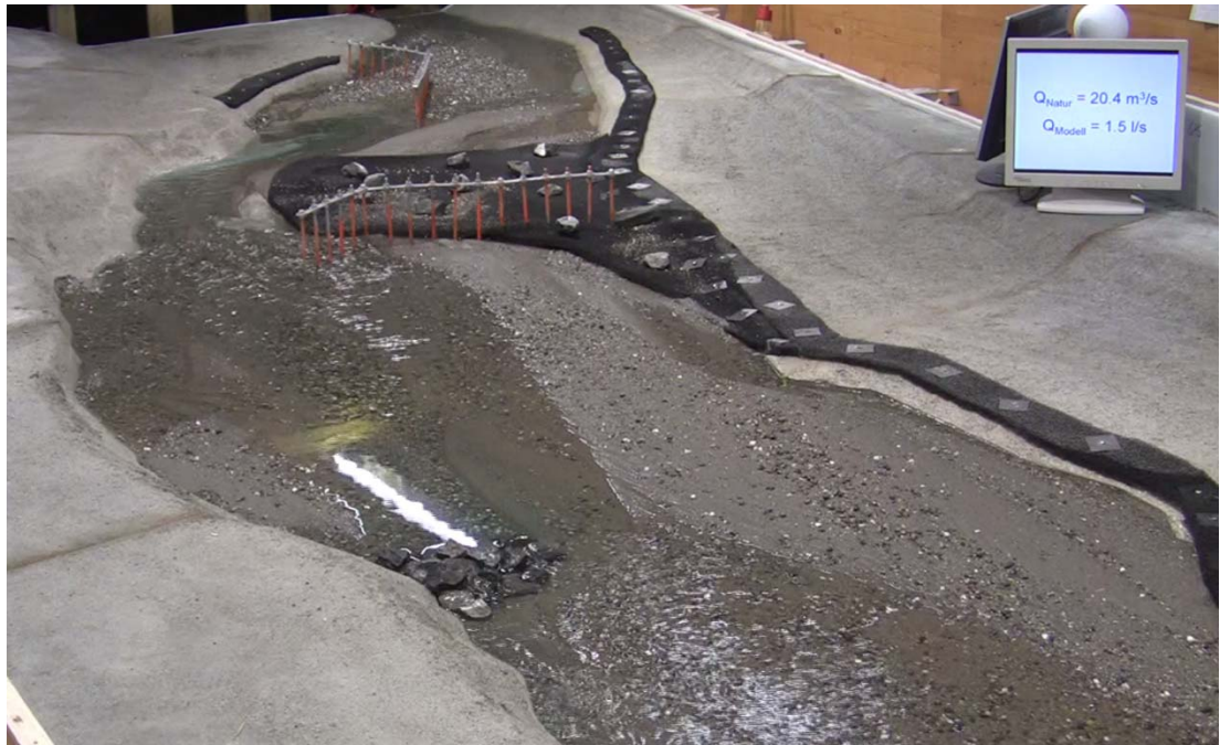
Abb. 7-6: Strömungslage vor dem Versuch. Es ist keine deutliche Niederwasserrinne ersichtlich.
