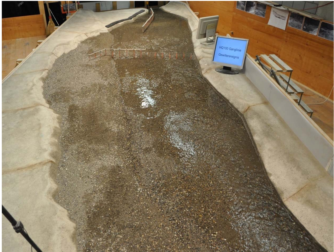
Abb. 9-10: Das Gerinne ist an den rechten Hangfuss verlagert und der Wald entfernt worden.
