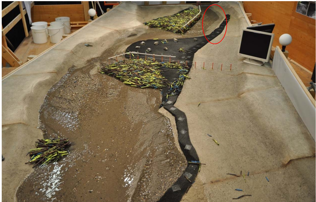
Abb. 8-18: Schwemmholz- und Geschiebeablagerungen nach dem Versuch C8_1.1_280G sowie erodierte Sohle im Gerinne neben dem Parallelrechen (rot).
