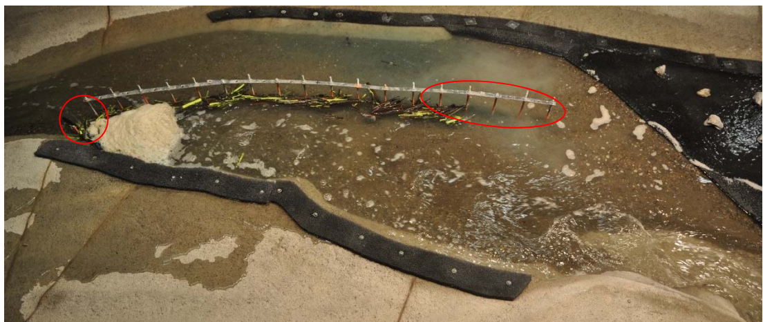
Abb. 9-1: Die Verklausungen im oberen Drittel (rot markiert) des Parallelrechens lösen sich bis zur Hochwasserspitze auf.
