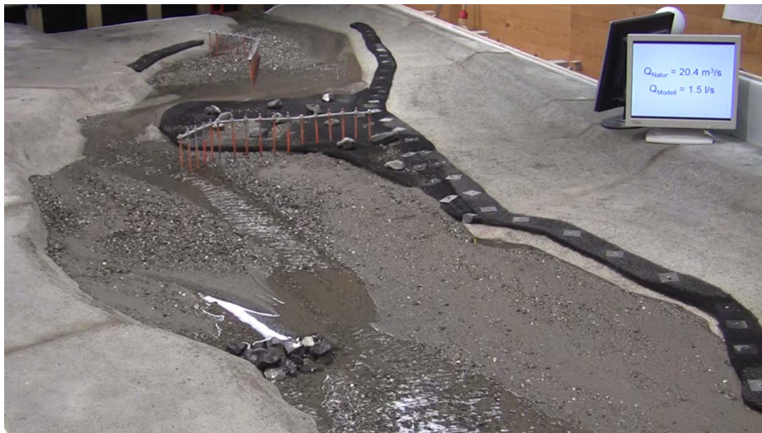
Abb. 7-8: Strömungslage vor dem Versuch. Die Niederwasserrinne zielt auf den linken Teil des V-Rechens.
