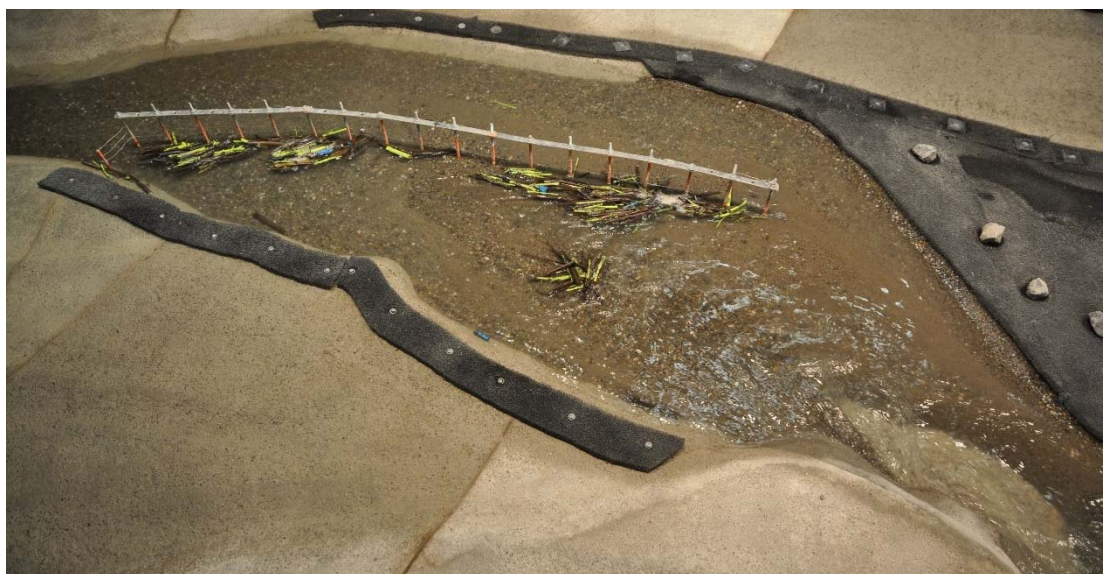
Abb. 8-8: Teilverklauster Parallelrechen nach der ersten Schwemmholzfracht von 300 \text{ m}^3 fest.
