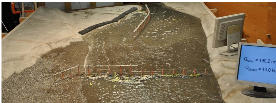
Abb. 9-11: Die erste Schwemmh Holzfracht wird beinahe komplett durch den V- und Parallelrechen zurückgehalten.
