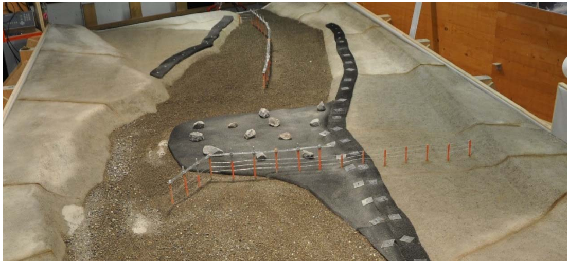
Abb. 7-16: Erweiterter Parallelrechen und bis an den Hangfuss verlängerter V-Rechen.
