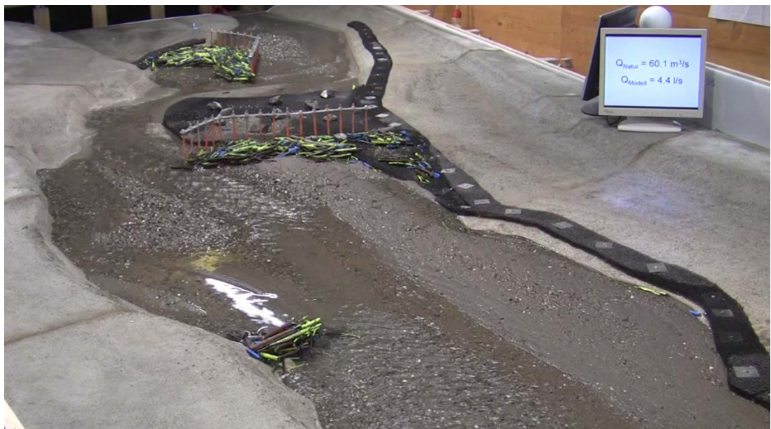
Abb. 7-7: Deutlich sichtbar ist die entstandene Geschiebebank im Strömungsschatten der Buhne.
