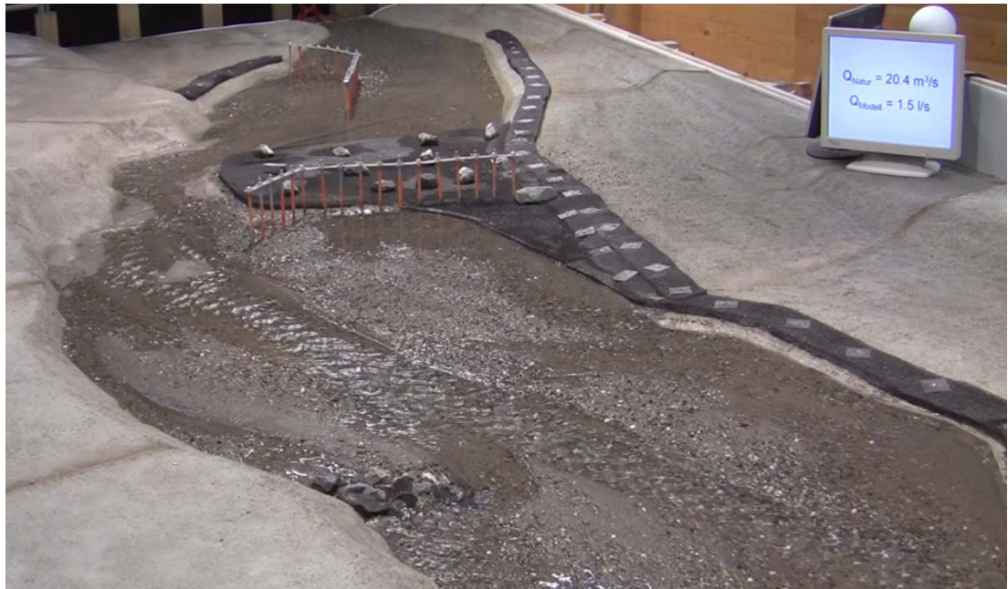
Abb. 7-10: Strömungslage vor dem Versuch. Die Niederwasserrinne zielt links am V-Rechen vorbei.
