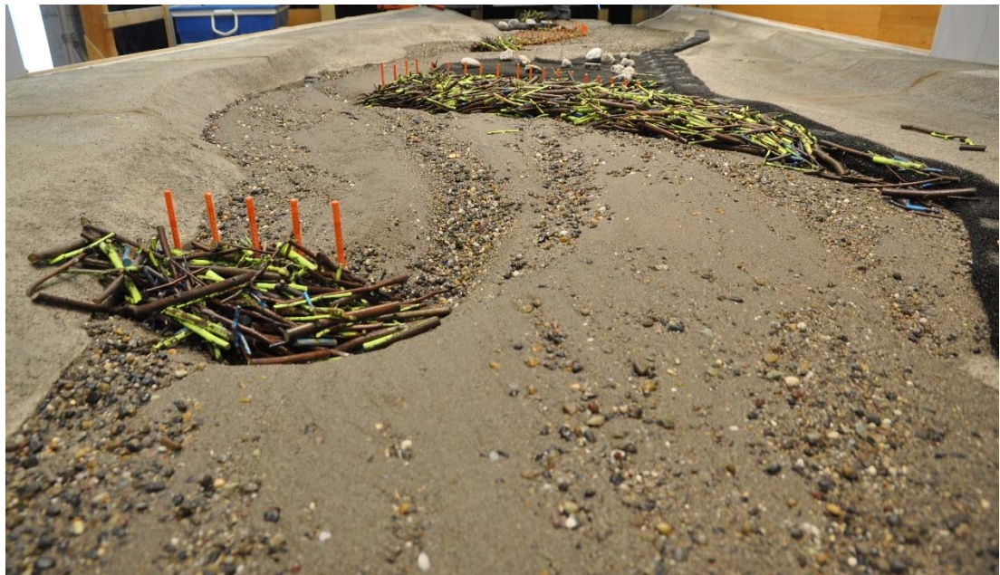
Abb. 6-4: Schwemmh Holz zurück halt es system mit Parallelrechen, V-Rechen und Querrechen.
