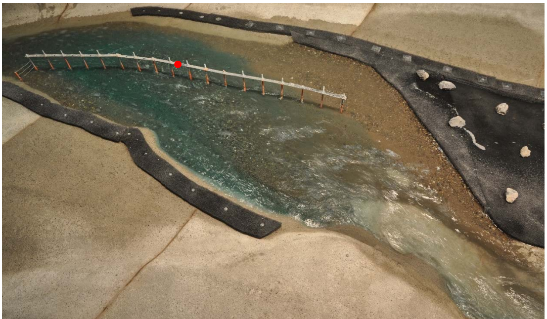
Abb. 7-45: Strömungslage bei einem Abfluss von 150 \text{ m}^3/\text{s} . Die Mitte des Parallelrechens ist mit einem roten Punkt markiert.
