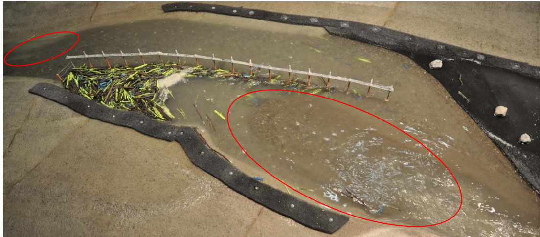
Abb. 8-11: Geschiebe- und Schwemmholzablagerung im Parallelrechen. Die Geschiebeablagerung oberhalb und die erodierte Sohle unterhalb des Parallelrechens sind rot markiert.
