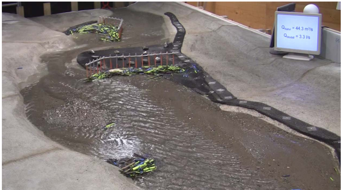
Abb. 7-11: Die entstandene Geschiebebank im Strömungsschatten der Buhne ist deutlich sichtbar.
