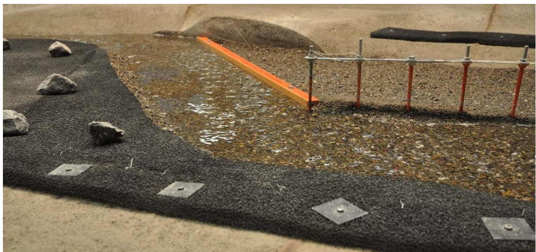
Abb. 7-36: Der Niederwasserabfluss um den Parallelrechen (Fließrichtung von links nach rechts).
