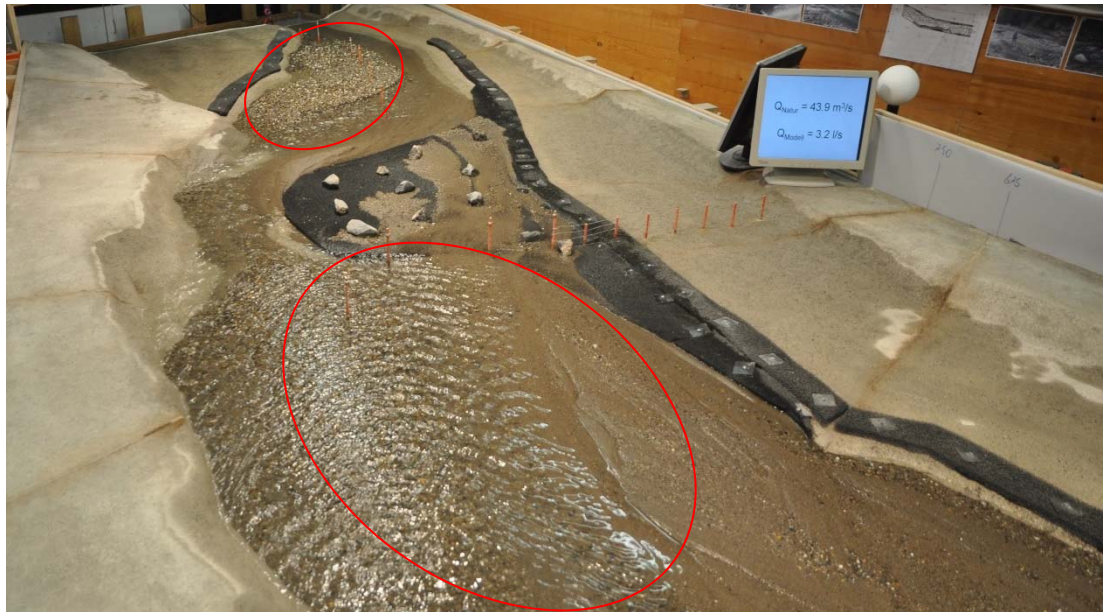
Abb. 8-7: Deutlich ersichtliche Geschiebeablagerungen in den aufgeweiteten Bereichen.
