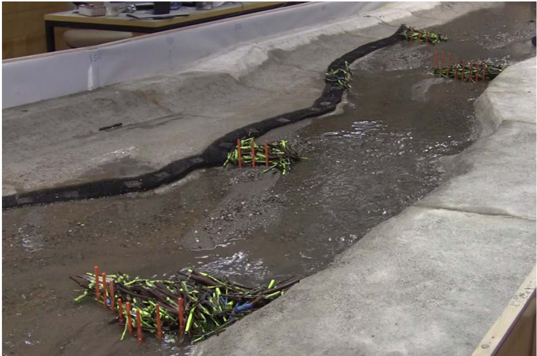
Abb. 6-6: Rechensystem 4 bestehend aus je zwei Rechen zur Strömungslenkung und zwei V-Rechen.
