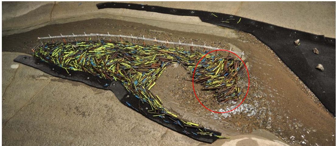
Abb. 9-5: Teilverklauung der Rechenöffnung infolge der Auflandung im Parallelrechen.
