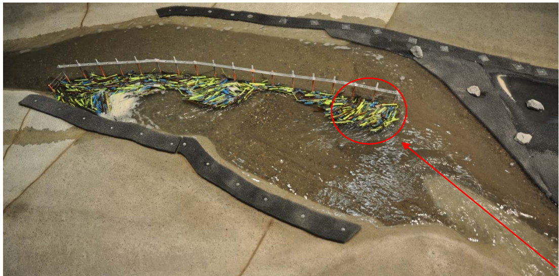
Abb. 7-24: Infolge der Strömungslage, siehe roter Pfeil, kommt es im Bereich der Öffnung des Parallelrechens zu einer Teilverklausung bei der ersten Schwemmholzfracht (roter Kreis).
