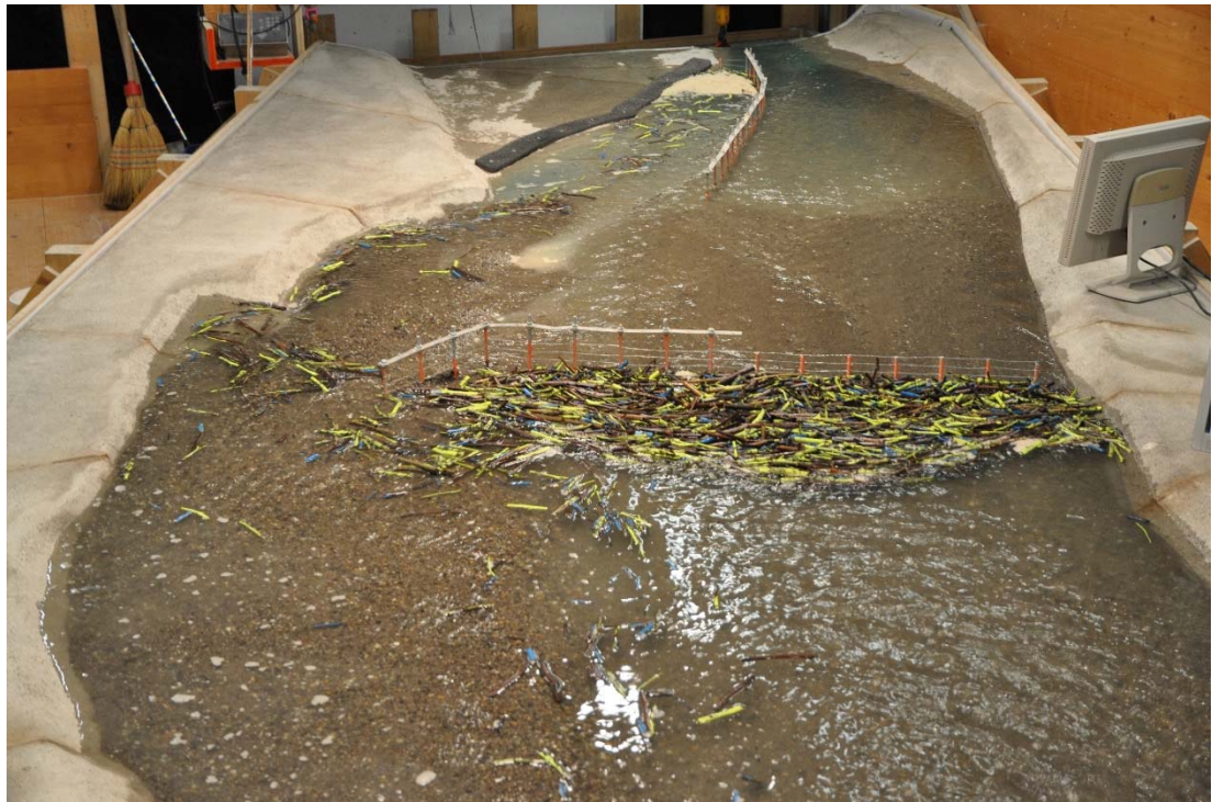
Abb. 9-12: Der V-Rechen wird trotz massiver Auflandung am linken Hangfuss nach dessen Verklausung linksseitig umströmt.
