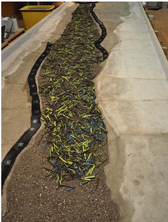
Abb. 9-8: Die gesamte Schwemmholzfracht (2'000 m 3 ) wird in das trockene Gerinne gelegt.
