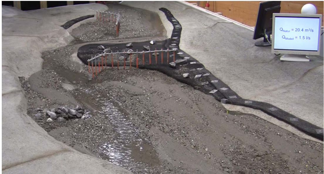
Abb. 7-3: Strömungslage vor dem Versuch. Die Strömung zielt links am V-Rechen vorbei.
