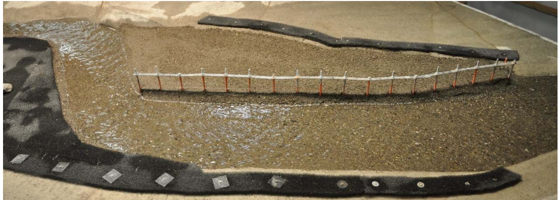
Abb. 9-3: Ausgangslage des Versuches D8_2.1_210G. Auflandung im Parallelrechen mit einer Höhe von 2 m.
