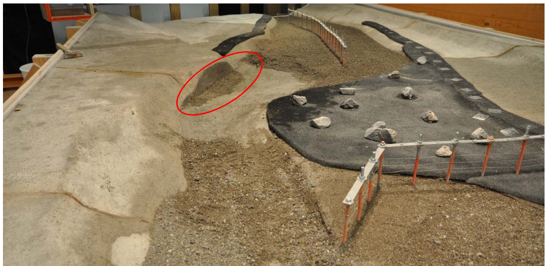
Abb. 7-25: Abtrag der Felsnase im Bereich M800 bis M825, zur Strömungsoptimierung.
