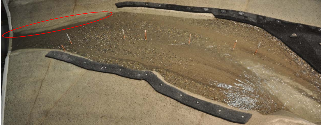
Abb. 8-12: Entstehende Geschiebeablagerung im Bereich des geplanten Parallelrechens. Sowie erodierte Sohle im Abschnitt M900 bis M950 (rot).
