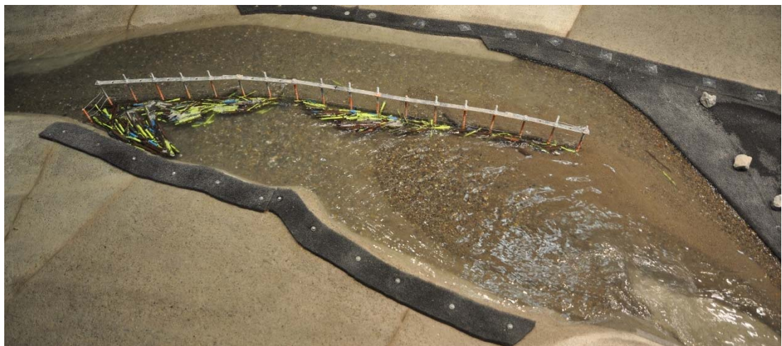
Abb. 8-4: Auf ganzer Länge verklauster Parallelrechen infolge der ersten Schwemmholzfracht.
