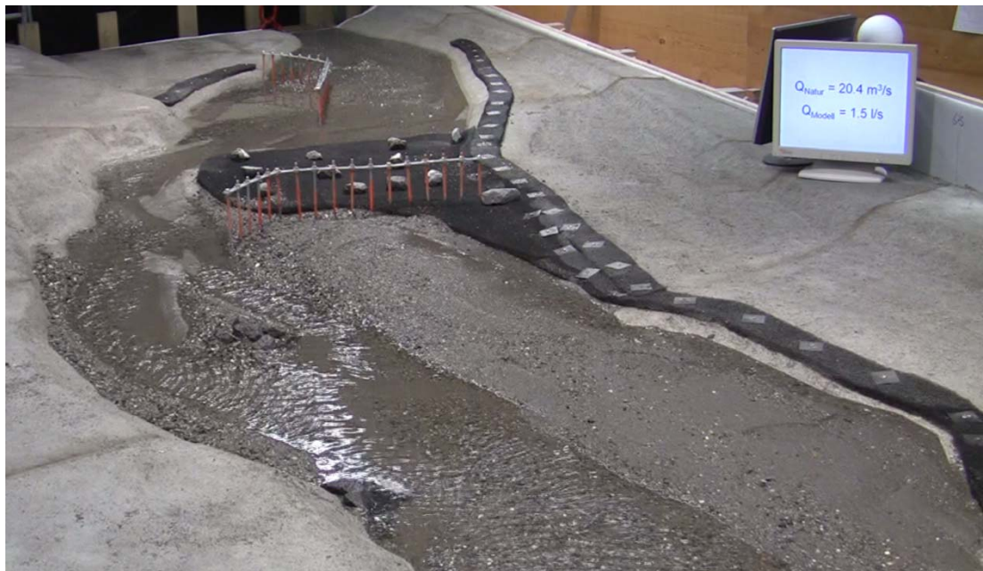
Abb. 7-12: Strömungslage vor dem Versuch. Die Niederwasserrinnen zielen links am V-Rechen vorbei.
