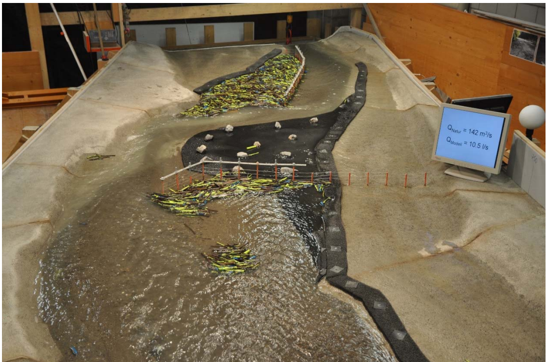
Abb. 7-53: Schwemmholzrückhalt nach vier Schwemmholzfrachten des Versuches B8_2.1_119_142S.
