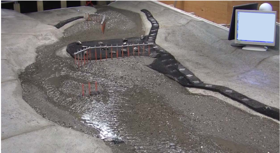
Abb. 7-14: Strömungslage vor dem Versuch. Die Niederwasserrinnen zielen links am V-Rechen vorbei.
