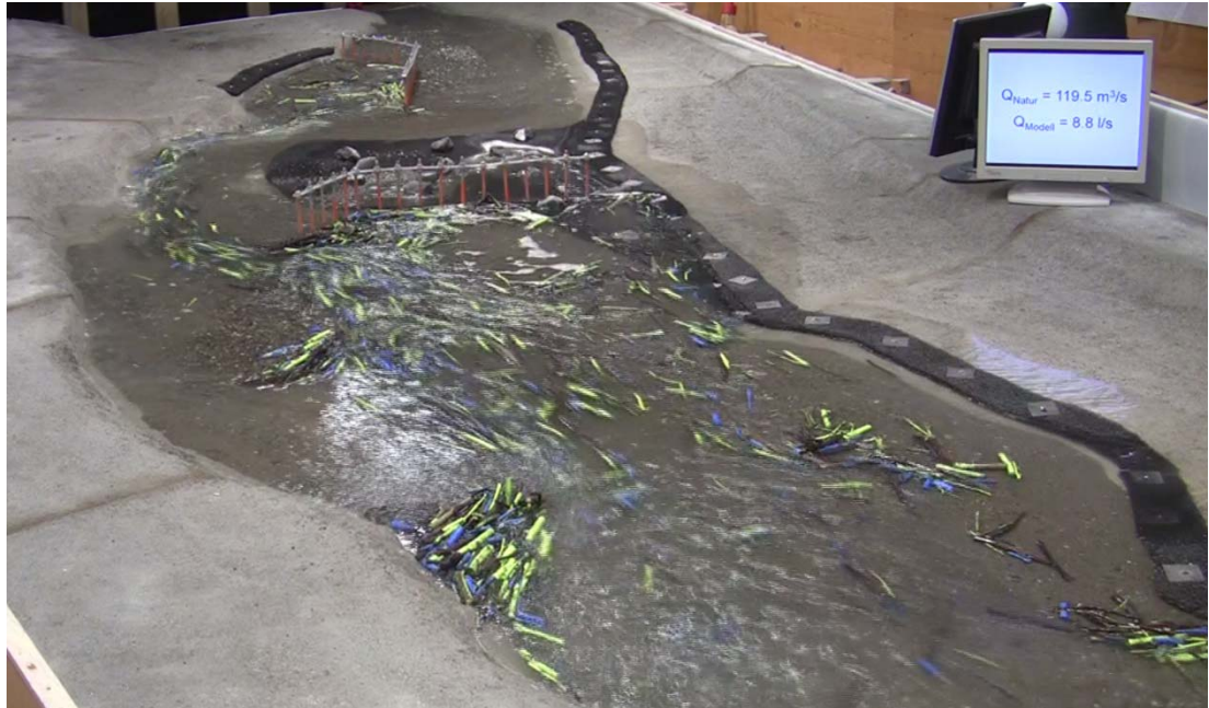
Abb. 7-9: Die Strömung wird durch die Buhne und Kiesbank direkt in den V-Rechen gelenkt.
