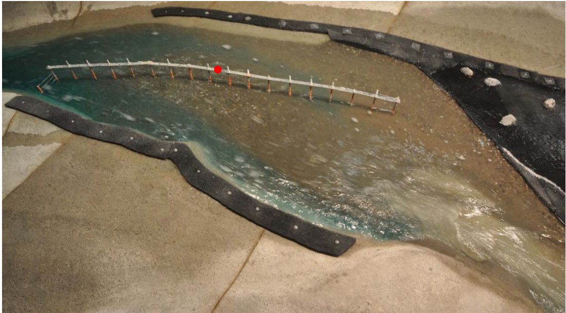
Abb. 7-46: Strömungslage bei einem Abfluss von 210 \text{ m}^3/\text{s} . Die Mitte des Parallelrechens ist mit einem roten Punkt markiert.
