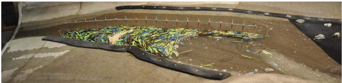
Abb. 7-19: Parallelrechen nach der zweiten Schwemmh Holzfracht von 720 m 3 fest.
