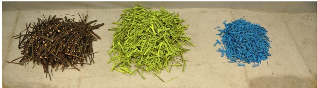
Abb. 6-1: Schwemmholtzmenge von 1200 \text{ m}^3 in drei Fraktionen aufgeteilt.
