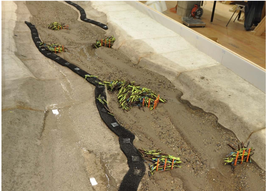
Abb. 6-5: Rechensystem 3 aus zwei V-Rechen mit jeweils zwei dazugehörigen Querrechen.
