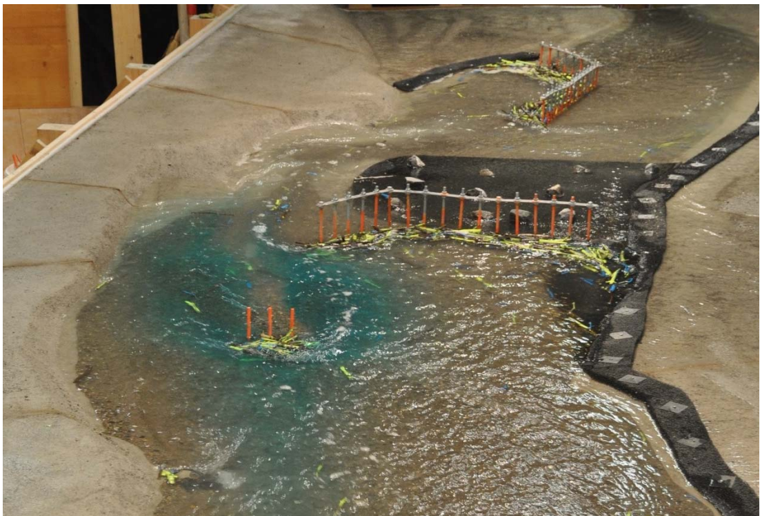
Abb. 7-15: Durch die Insel wird die Strömung geteilt, jedoch nicht in den V-Rechen gelenkt.
