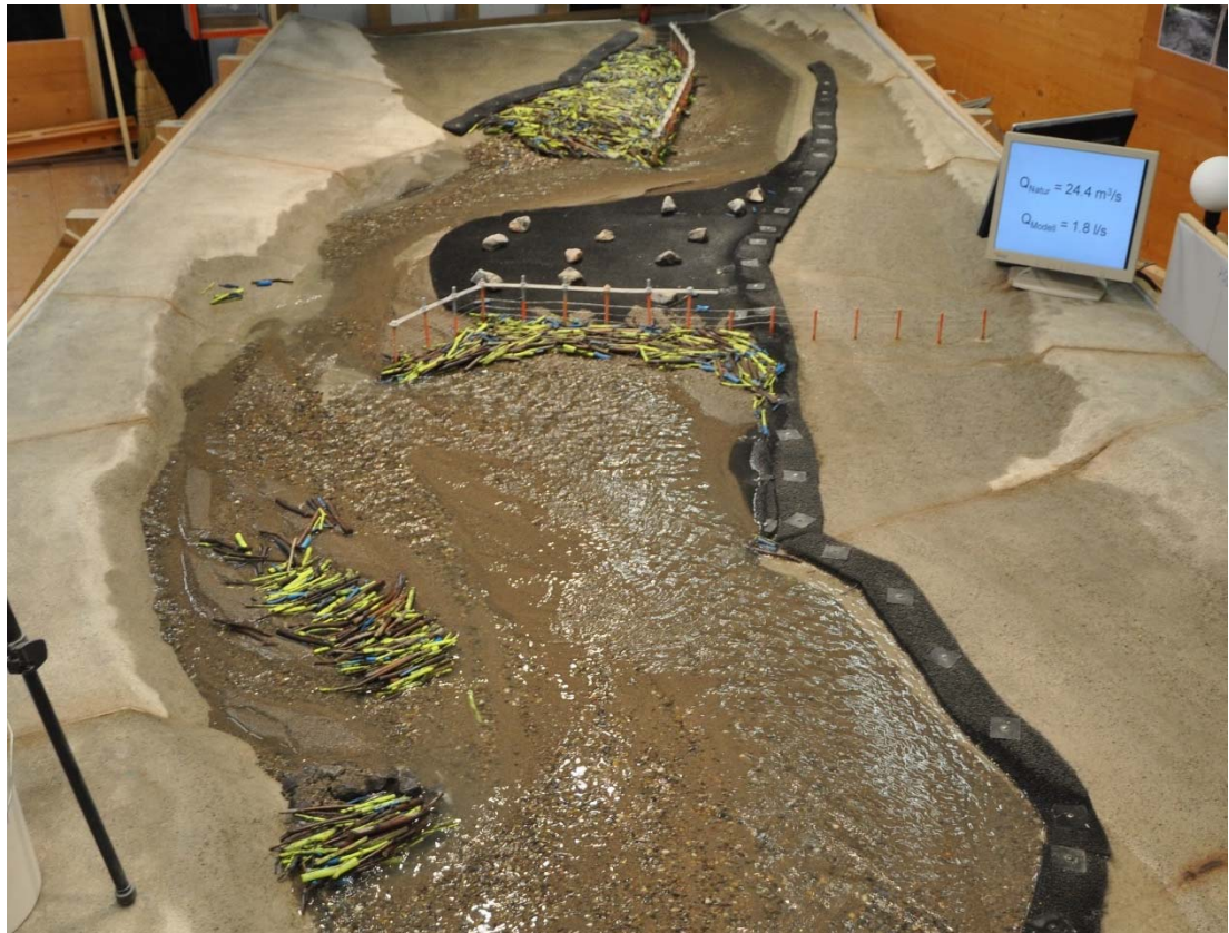
Abb. 7-50: Beinahe die gesamten 2000 m 3 Schwemmholz können durch den Parallelrechen und den V-Rechen zurückgehalten werden.
